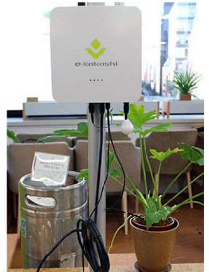
図2 e-kakashi。各種センサーを差し込んで電源スイッチを入れればすぐ稼働する。雨や雪、夏の日差しにも耐えるタフネス性能
